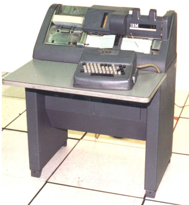
Kuva 2: Reikäkorttien lävistyskone, jolla operaattori teki kortteihin tarvittavat pisteet.
